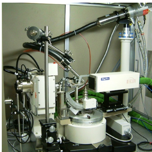
図 3: 山口大学総合科学実験センター 機器分析実験施設 (旧・機器分析センター) 内設置の単結晶 X 線回折機器、Mercury CCD System(Rigaku) の様子 . 使用 X 線は Mo K\alpha 線 (波長 \lambda = 0.71069 \text{ \AA} ) であり、一般によく用いられる特性 X 線である .
